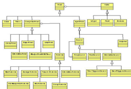
그림 16 제어 루프 프레임워크의 전체 설계
