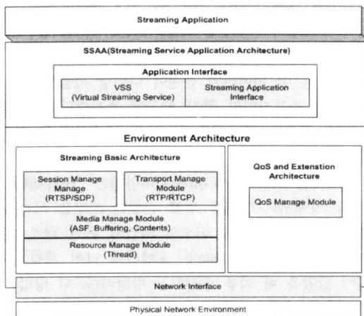
그림 1. MPEG-2 AAC 스트리밍 시스템의 모델 구조
