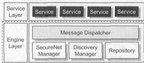
그림 1. XML 기반 글로벌 P2P 엔진 구조
